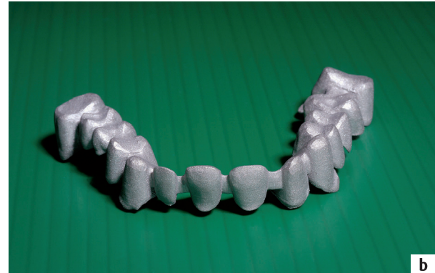
Fig. 4.2 (a) Con los sistemas CAD/CAM no se realizan solamente trabajos con técnicas de corte. La figura muestra un ejemplo de tecnología “laser moulding” para la realización de prótesis en metal a partir de polvo. Fases iniciales de la producción. (b) Subestructura “full arch” en aleación cromo-cobalto al terminar el modelo (Sistema Echo, Sweden&Martina).
